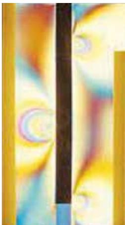
Gerade Schäfte erzeugen Spannungsspitzen in einer anatomisch S-förmigen Markhöhle.
