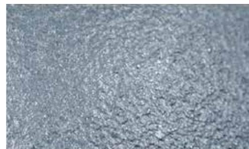
Ti6Al4V mit poröser Titan-Beschichtung, vergrößert
