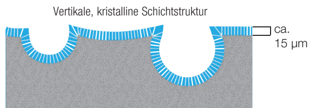
Abb.: PoroLink* mit HX**-Beschichtung. Schematischer Querschnitt beschichteter Oberflächen.
